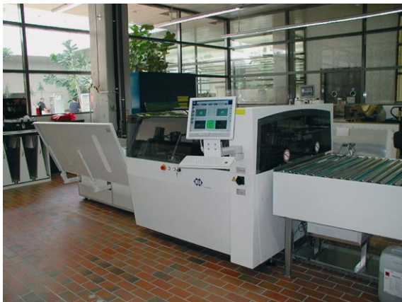
Stanz-/Abkantanlage mit VCPnet Bedienterminal in der Druckvorstufe
