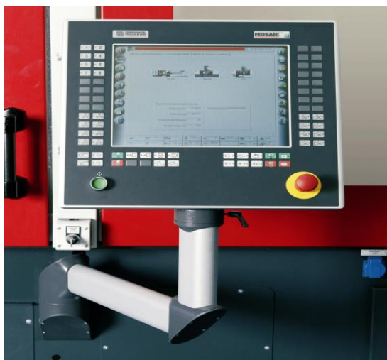
MOSAIC-Bedienterminal auf Schwenkarm
